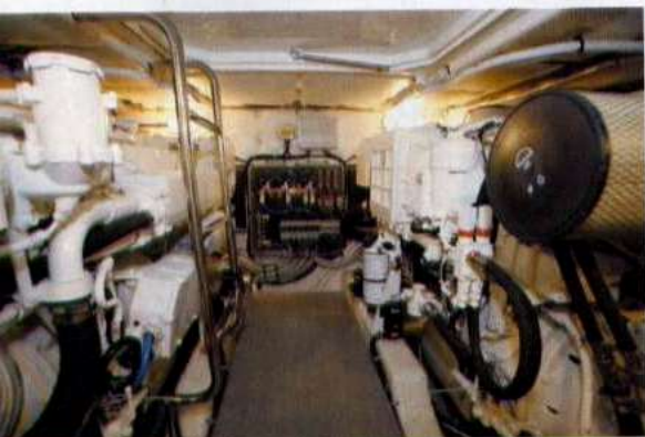
La sala motori ospita due entrobordo con V Drive e potenze da 720 a 800 cv.
